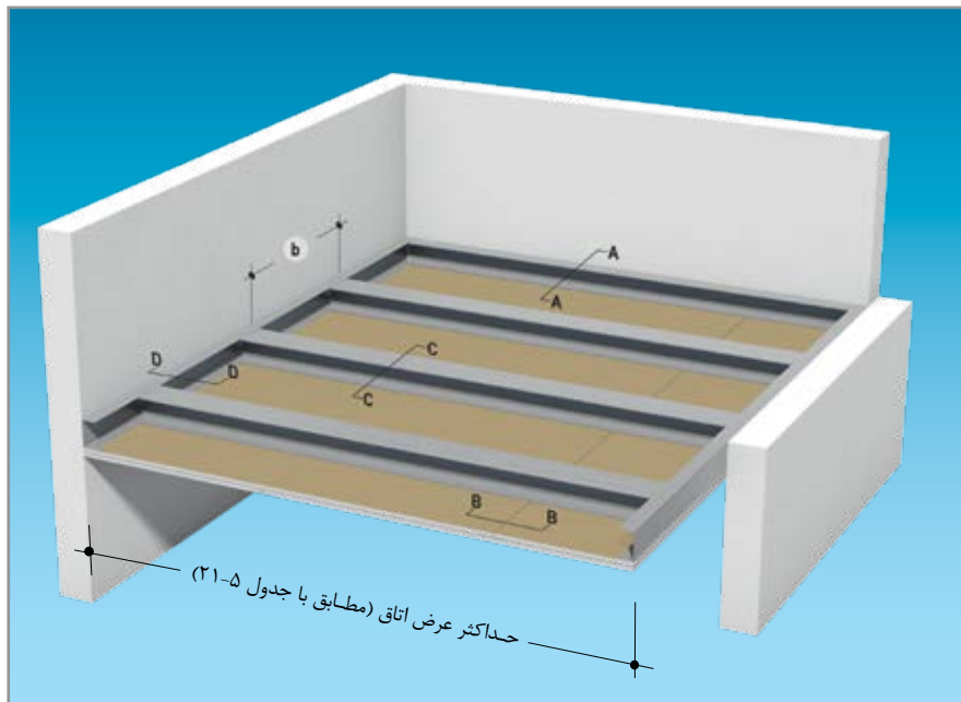
اتصال سازه تراز باربر به دیوار کناف (برش D-D)
