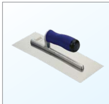
ماله استیل: جهت پرداخت سطوح با قابلیت نصب شانه‌های مختلف برای کاشیکاری، اجرای ساتن سمنت (ماله آکواپنل مدل دنداندار) با قابلیت تعیین ضخامت ملات
